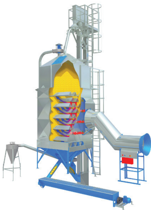
شکل ۲۸- تصویری از خشک کن ایستاده برای خشک کردن بذر
