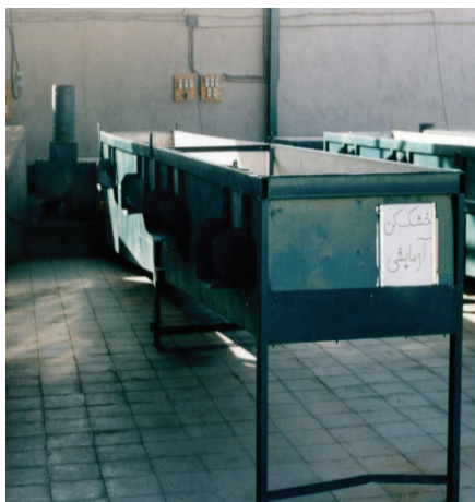
شکل ۹- نمونه ای از خشک کن های وعده ای بستر ثابت پسته
