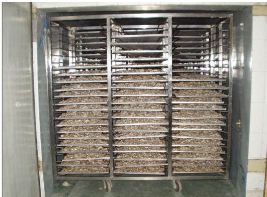
شکل ۲۳- ساختار نمونه ای از خشک کن تونلی مورد استفاده
