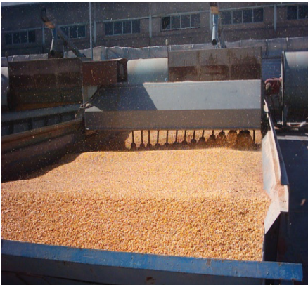
شکل ۱۰- خشک کن های وعده ای ذرت دانه ای مجهز به سیستم همزن
