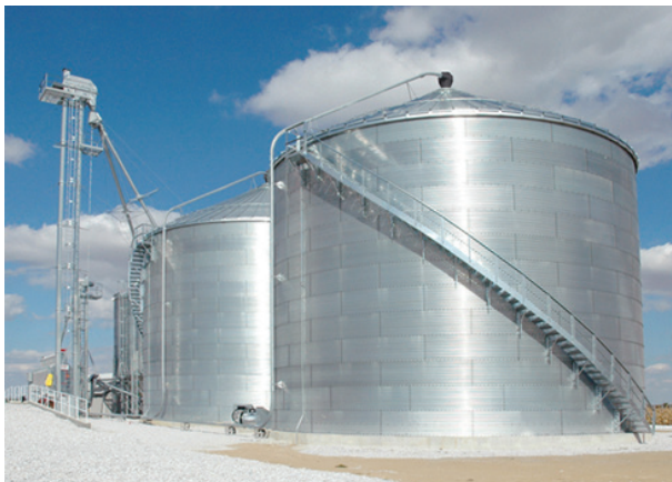
شکل ۱۳- نمایی از خشک کن های مخزنی مورد استفاده در کشاورزی
