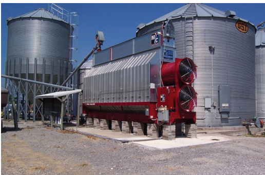
شکل ۱۷- خشک کن های جریان پیوسته با مخازن استراحت
