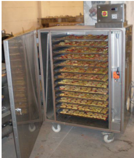
شکل ۲۲- ساختار نمونه ای از خشک کن های کابینتی سینی دار برای خشک کردن میوه و سبزی ها ( ادامه در صفحه بعد)
